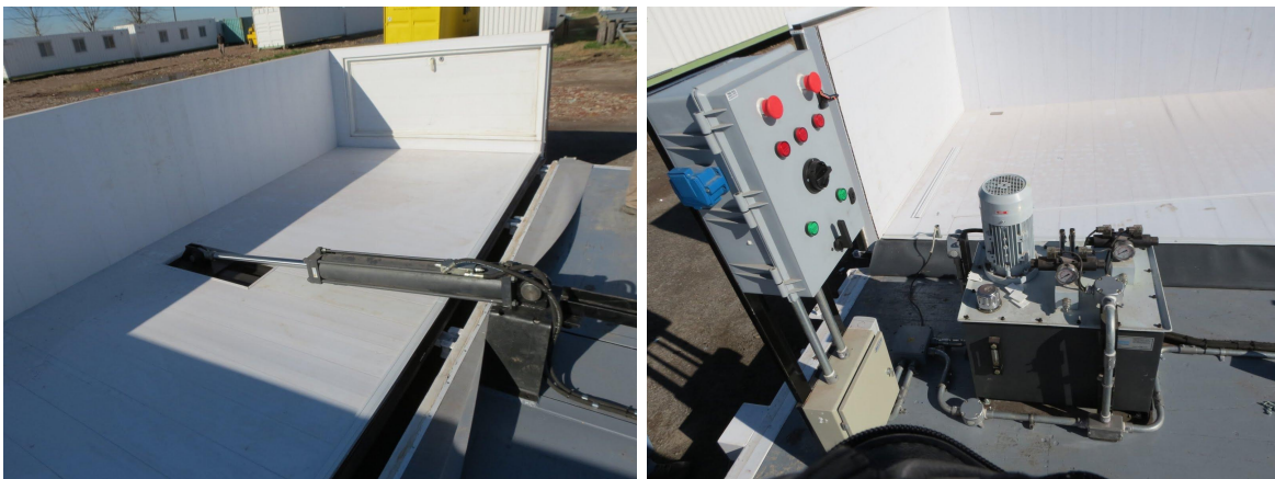
Figura 4.2.15: Imagen de uno de los cilindros de apertura cierre (derecha), y sistema de bomba y panel de control (izquierda).
