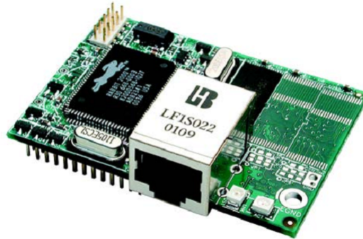
Figura 4.3.5: Módulo Rabbit RCM 2200. En la capa inferior, se pueden observar los pines de entrada/salida.
